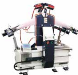
FSF3 Acabado de planchado de camisas
