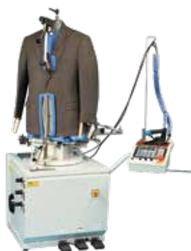
FFT-WC Acabado multiforme de chaquetas
